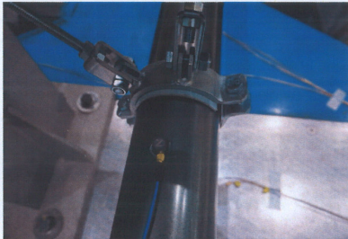
Photo B.19 시험 전 UUT-3 절연체 설치상태
