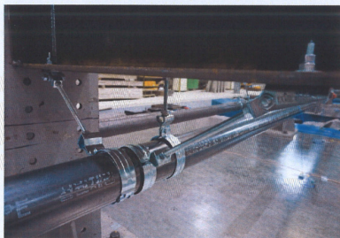
Photo B.5 시험 전 UUT-1 행거
