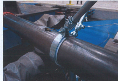
Photo B.20 시험 전 UUT-4 절연체 설치상태
