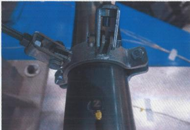
Photo B.17 시험 후 UUT-1 흔들림방지버팀대(근접)
