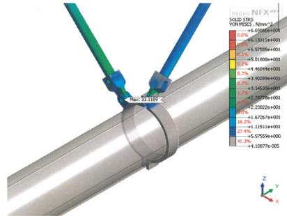
Fig. 10 최대응력 결과(Max. Von-Mises Stress) / 배관연결장치 / 33.12 MPa
