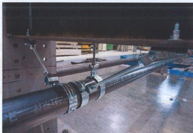
Photo B.5 시험 전 UUT-1 행거
