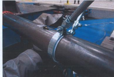
Photo B.20 시험 전 UUT-4 절연체 설치상태
