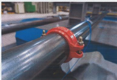
Photo B.7 시험 전 UUT-1 그루브조인트
