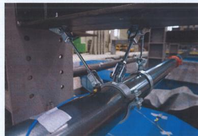
Photo B.6 시험 전 UUT-1 흔들림방지버팀대
