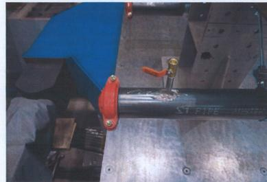
Photo B.4 시험 전 UUT-1 좌측 단부
