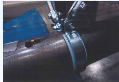
Photo B.22 시험 후 UUT-4 절연체 설치상태
